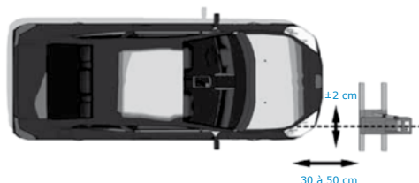
Positionnement d'un appareil de réglage des feux
