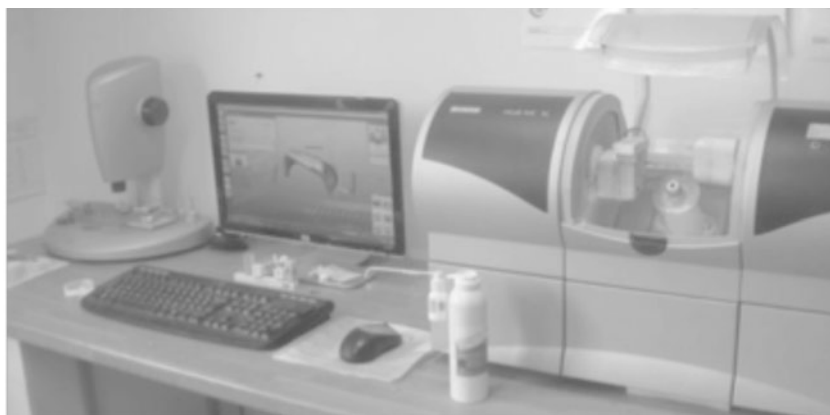
Fig. 14 – Chaîne prothétique indirecte. De gauche à droite : le scanner, la CAO, le robot d'usinage.
