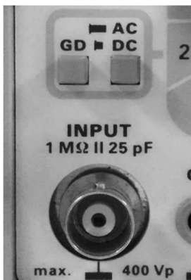
Bouton de sélection du couplage AC sur un oscilloscope analogique
