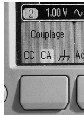
Menu de sélection du couplage AC sur un oscilloscope numérique
