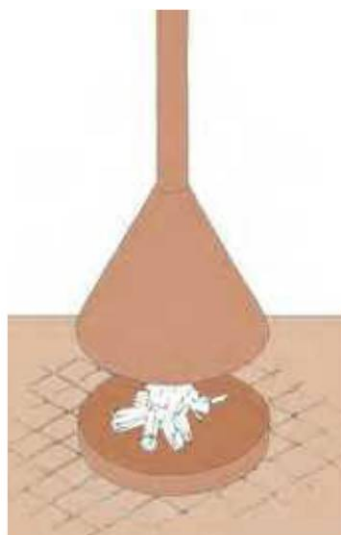
Conduit dont la section est insuffisante.
