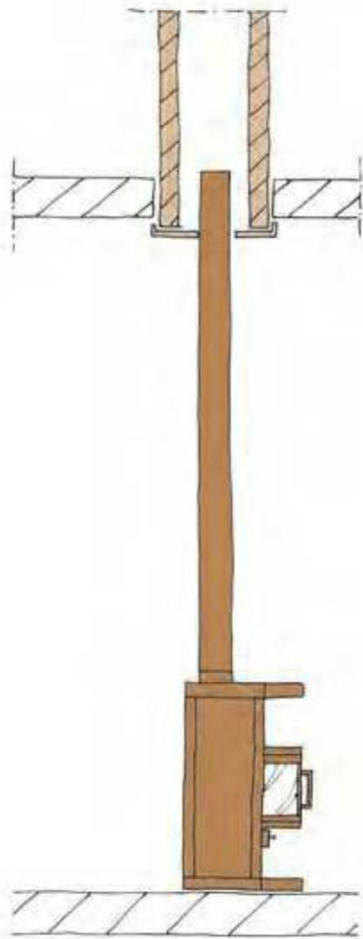
Poêles raccordés à d'anciens conduits de cheminée.
