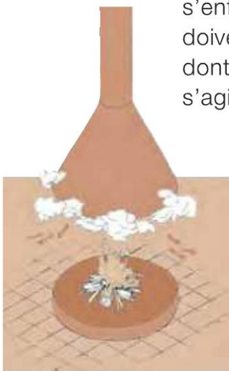
Hotte trop haute. Les fumées ne sont pas aspirées, danger mortel.
