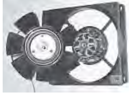
Figure 12.18 Motoventilateur de refroidissement du microprocesseur d'un PC. Moteur de quelques watts, 12 volts, 2p = 4 pôles. Rotor extérieur en chapeau.
