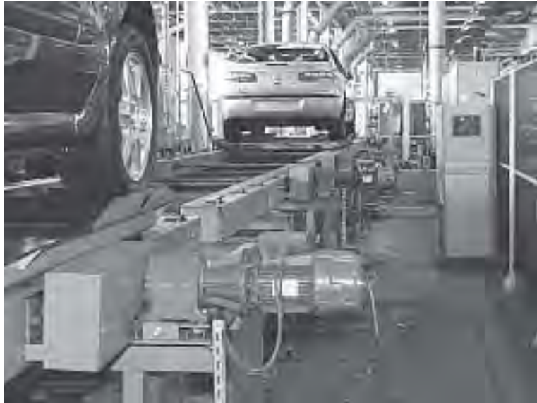
Figure 17.5 Usine Renault (Sandouville) : convoyeur final de banc de roulement du modèle Laguna.
