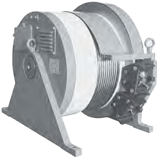
Figure 17.4 Moteur asynchrone de type Gearless, à faible vitesse de rotation, de l'ordre de 200 tr/min, sans réducteur mécanique et à commande électronique pour la traction d'une cabine d'ascenseur.
