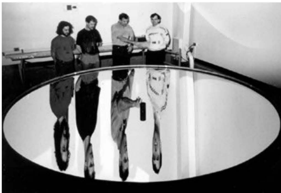
Figure 48 Un miroir en gallium liquide construit par l'équipe de E. Borra.
