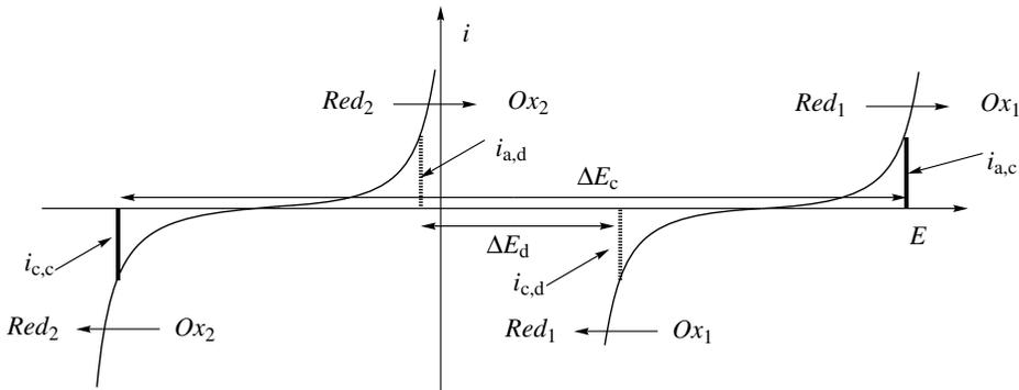
**Figure 9.7** – Courbes intensité-potentiel dans le cas de deux électrodes : fonctionnement en générateur (courbes en pointillés) et fonctionnement en électrolyse (courbes pleines)
