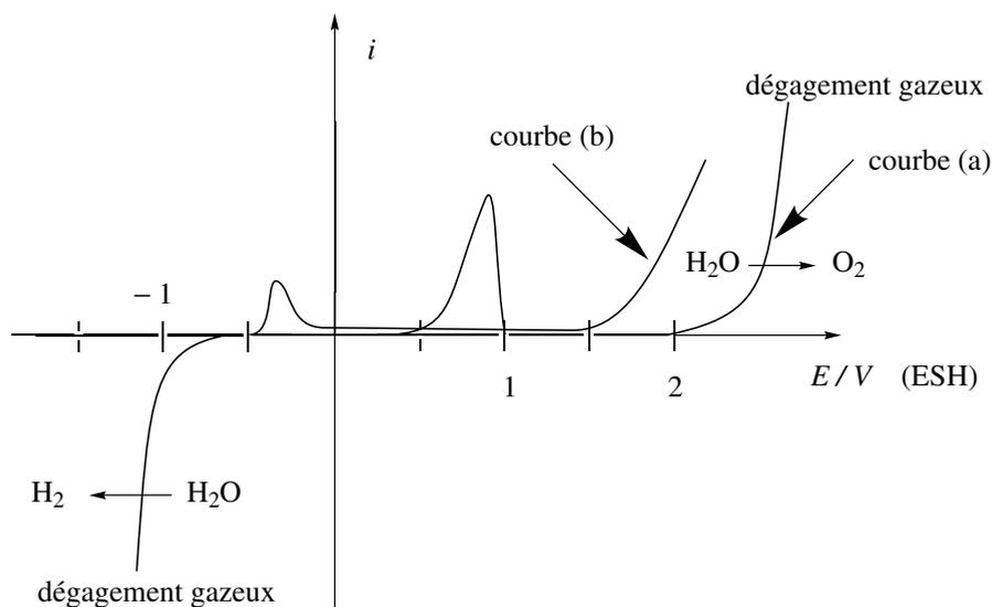
**Figure 9.12** – Courbes intensité-potentiel d'une électrode de plomb : (a) solution aqueuse d'acide sulfurique molaire et (b) solution aqueuse d'acide sulfurique molaire avec du chlorure de sodium à  $30 \text{ g}\cdot\text{L}^{-1}$
