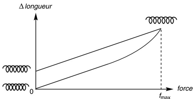
**Figure 1.3** – Exemple de phénomène d'hystérésis : utilisation d'un ressort en dehors de son domaine d'élasticité
