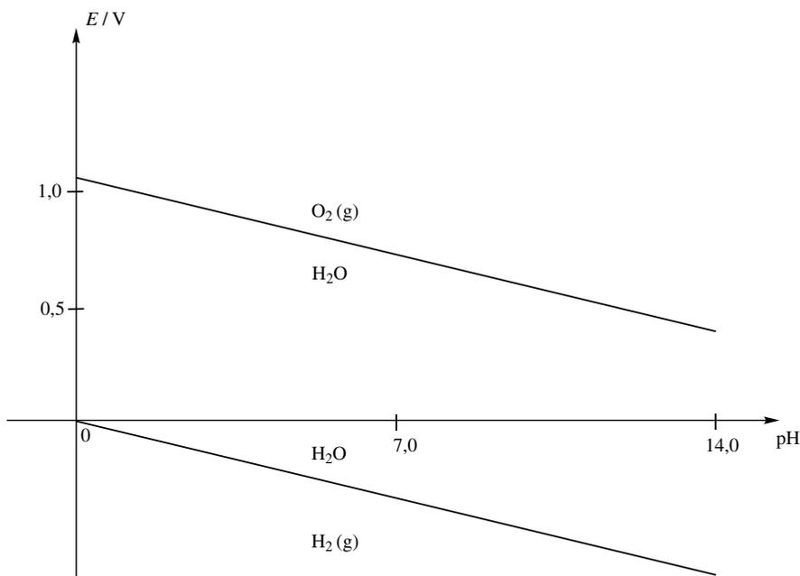
**Figure 8.2** – Diagramme potentiel-pH de l'eau
