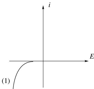
**Figure 9.17** – Diagramme intensité-potentiel de réduction de  $\text{Ni}^{2+}(\text{aq})$
