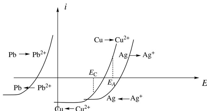
Figure 9.16 – Courbes intensité-potential des couples plomb, cuivre et argent
