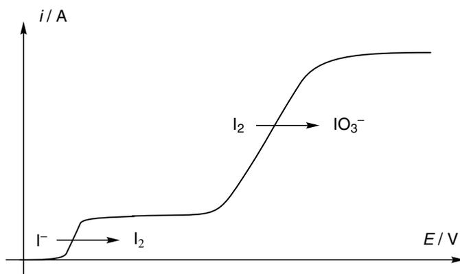
**Figure 9.6** – Courbe intensité-potential relative à l'oxydation d'une solution d'ions iodure
