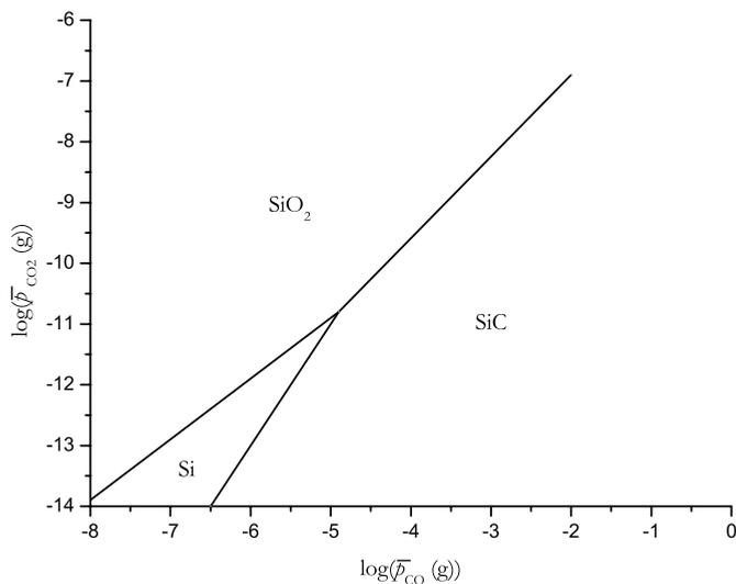
**Figure 7.21** – Diagramme de stabilité thermodynamique du système Si-C-O à 1500 K
