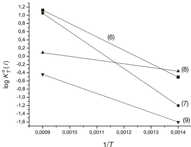
Logarithme décimal des constantes de réactions en fonction de l'inverse de la température pour la réduction des oxydes de tungstène par le dihydrogène
