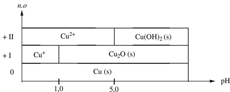
Figure 8.8 – Diagramme de situation du cuivre
