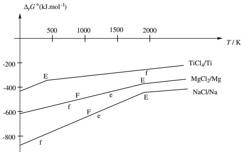
Figure 7.17 – Diagramme d'ELLINGHAM pour le dichlore réactif oxydant et les métaux Ti, Mg et Na
