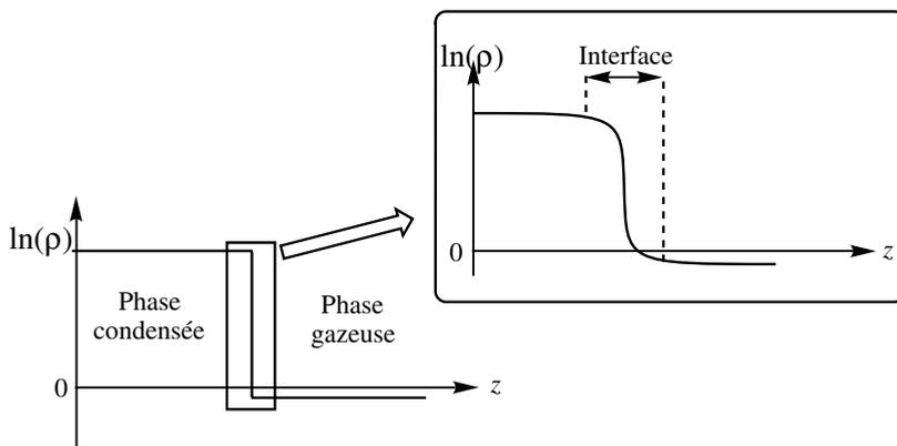
**Figure 3.1** – Variation du logarithme de la masse volumique en fonction de l'altitude pour un système comportant une interface liquide/gaz
