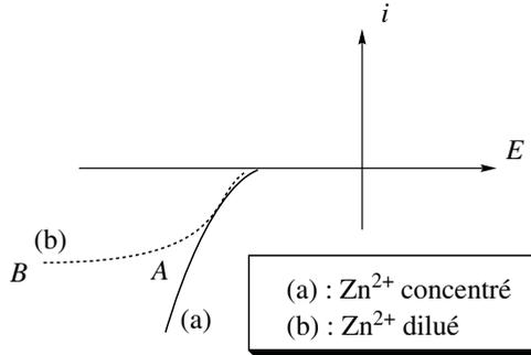
**Figure 9.19** – Courbe intensité-potentiel du couple  $Zn^{2+}/Zn$  en fonction de la concentration
