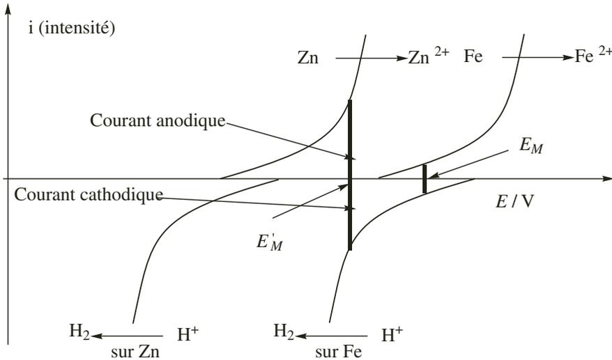
Figure 9.11 – Principe de la protection d'un métal par anode sacrificielle
