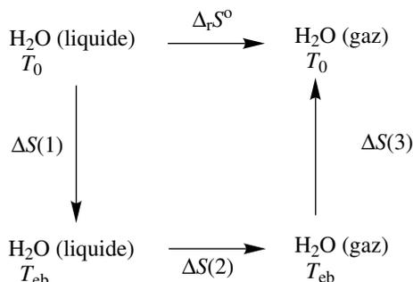
Cycle thermodynamique permettant le calcul de l'entropie molaire absolue de l'eau gaz sous  $p = 1 \text{ bar}$  et  $T = 298 \text{ K}$
