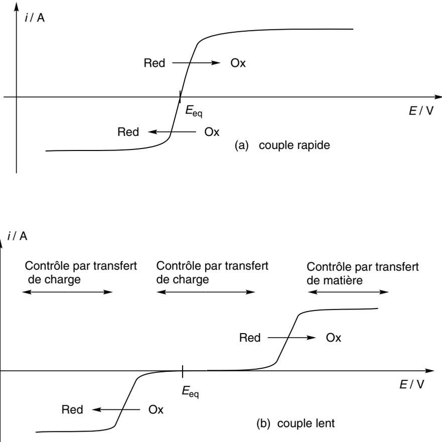
**Figure 9.3** – Courbes intensité-potentiel : (a) couple rapide et (b) couple lent
