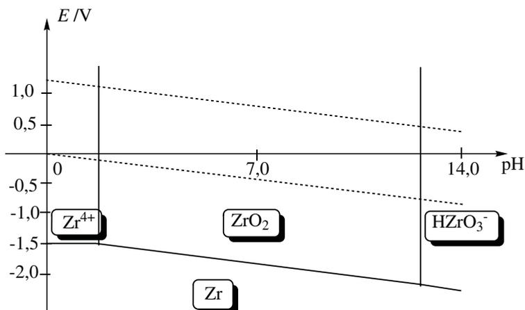
Le zirconium ne possède pas de domaine commun de stabilité avec l'eau : l'eau attaque donc le zirconium (Zr est oxydé en  $Zr^{4+}$ ,  $ZrO_2$  ou  $HZrO_3^-$  suivant le pH tandis que l'eau est réduite en dihydrogène).
