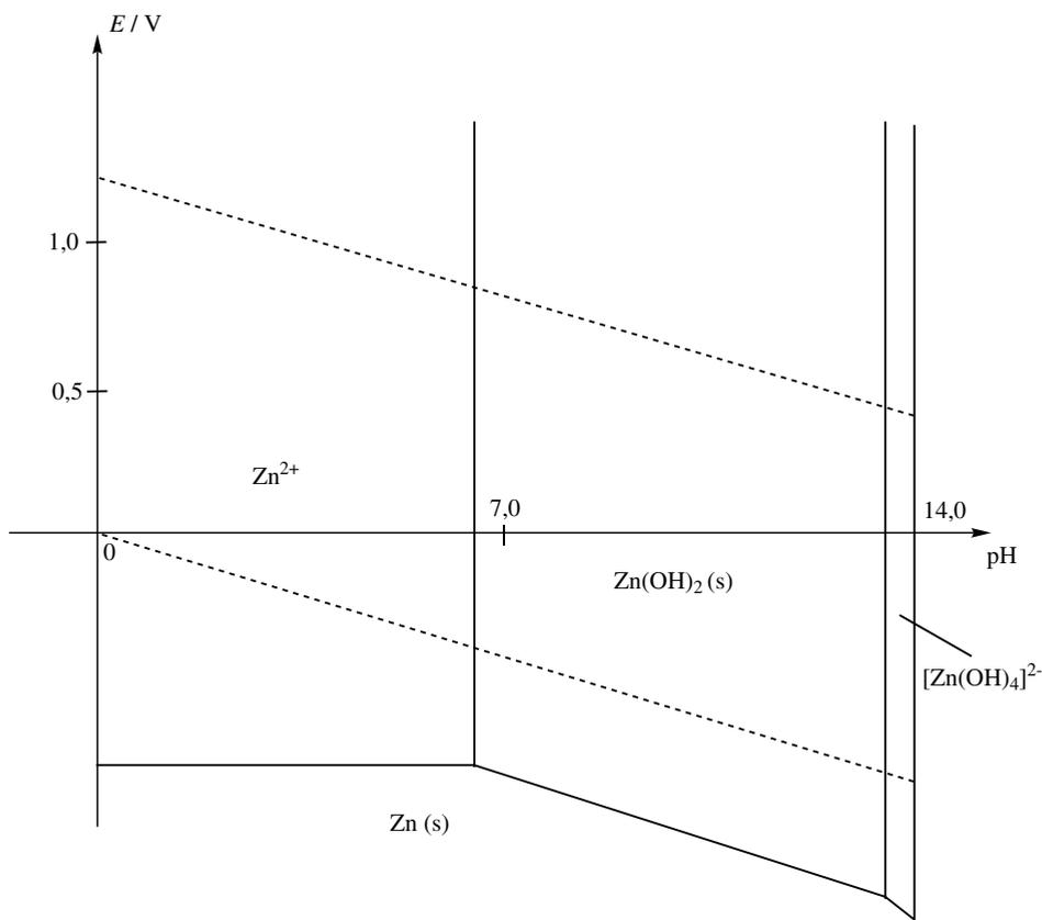
**Figure 8.7** – Diagramme potentiel-pH du zinc et de l'eau
