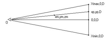
Le point M est visible si sa projection P est entre xmax et xmin, donc, d'après Thalès, xm/zm=xp/D, donc M est visible si :
