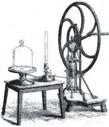
Figure 11.27. Nouvelle machine pneumatique à piston libre, de Louis-Joseph Deleuil, Annales de Chimie et de Physique , 1865, t. V, pp. 174-176.
