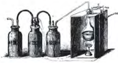
Figure 11.4. Appareil destiné à la production du protoxyde d'azote. Le régulateur, inventé par Kirby, est placé sur le flacon du milieu. Il se compose d'un levier, supportant le matras, et d'un poids mobile C pour le contrebalancer. Flacon n°1, rempli d'eau, à mi-hauteur. Il sert à rétablir l'équilibre en cas de défaut de pression. Flacon n° 2 contenant du sulfate de fer, surmonté d'un thermo-régulateur de Ash. Flacon n° 3 contenant de la potasse caustique en dissolution dans l'eau. Le gazomètre à cloche était en vente chez Claudius Ash 223 et Fils, au dépôt central, 7, 8, 9, Broad Street, Golden Square, à Londres. Stevens 224 , « Le protoxyde d'azote », Le Progrès Dentaire , 1874, p. 195, et feuillets publicitaires du Progrès Dentaire , 1879.
