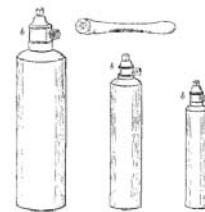
Figure 11.31. Bouteilles en fer, contenant du protoxyde d'azote liquide. Bouteille n° 1 (30 cm sur 8) : 150 litres de gaz à l'état liquide. Bouteille n° 2 (22 cm sur 7,5) : 225 litres. Coût : 61,50 F. Bouteille n° 3 (15 cm sur 5) : 112 litres. Coût : 41,50 F. D'après Stevens, « Du protoxyde d'azote », Le Progrès Dentaire , 1874, p. 198.
