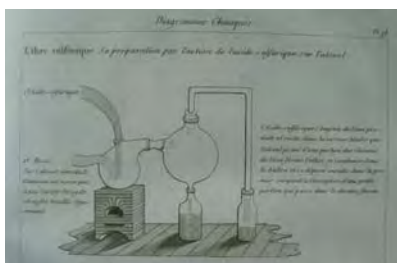
Figure 1.43. Préparation de l'éther sulfurique par l'action de l'acide sulfurique sur l'alcool.
