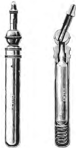
Figure 14.2. Porte-capsule métallique, imaginé par Knowles, en 1905, et fabriqué par la Dental Manufacturing Company , Lexington Street, à Londres. Il se présente sous la forme d'un tube et d'une gaine, sous laquelle était disposé un ressort pour la stabiliser. Le tube se termine par une boule et un bec, recouverts d'une coiffe, dont la pointe est protégée par un chapeau métallique. Un simple mouvement de torsion permettait de briser la capsule, sans que les particules de verre ne se répandent autour de l'inhalateur. L'Odontologie , 1905, vol. II, pp. 24-25.
