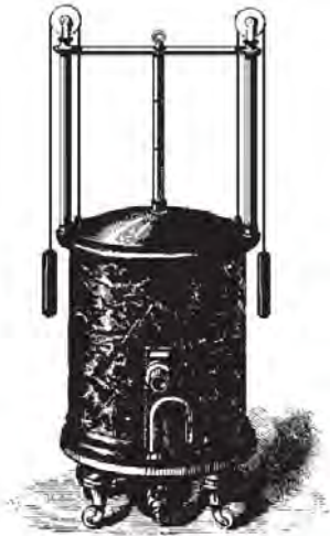
Figure 11.34. Gazomètre contenant du protoxyde d'azote liquide. En vente à la succursale parisienne de Claudius Ash et Fils, 100, rue de Richelieu, à Paris. Coût d'un gazomètre de 27 litres, en 1879 : 110 F ; de 36 litres : 125 F ; de 54 litres : 140 F. D'après Stevens, Le Progrès Dentaire , 1874, p. 199.
