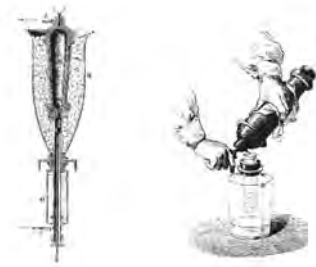
Figure 11.30. Liquéfaction du protoxyde d'azote et manière de se servir du gaz dans les laboratoires de chimie, d'après Jules-Henri Debray 227 .
