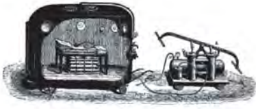
Figure 11.49. Cloche mobile de Jean A. Fontaine, reliée à une pompe à bras à double corps, avec un piston capable de produire 400 à 600 litres d'air à la minute. L'Union Médicale , le 18 septembre 1879.
