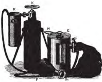
Figure 13.14. Appareil de Joseph Thomas Clover destiné à l'anesthésie mixte : protoxyde d'azote-éther, fabriqué par Mayer et Meltzer.
