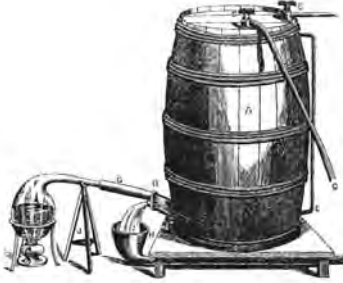
Figure 11.2. Préparation du protoxyde d'azote : premier modèle.
