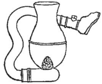
Figure 2.64. Appareil de Charrière, construit pour Jules Cloquet. Le réservoir, en forme de pipe, était en cuivre et contenait des étoupes ou du coton cardé imbibés d'éther. Il était posé sur un tube élastique, de 4 à 5 centimètres de diamètre (plus large que la trachée) et se terminait par un masque muni de deux soupapes 295 . L'appareil était livré avec deux sortes de masques, couvrant le nez, ou le nez et la bouche.
