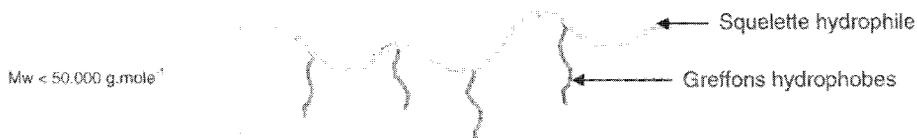
**Figure 3.** Structure du Géropon EGPM.
